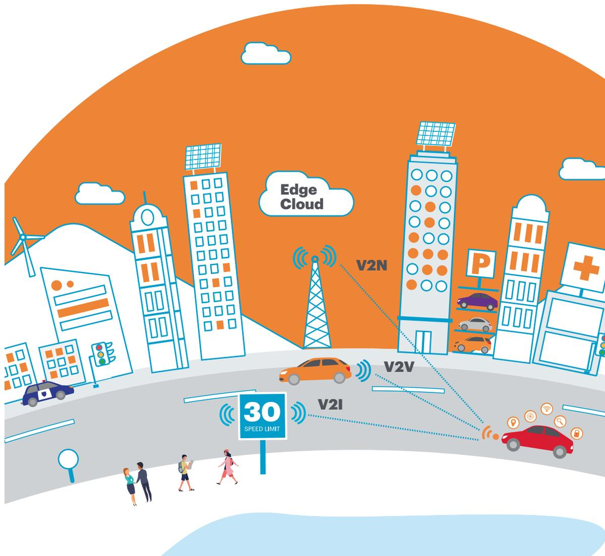
**Ilustración 16.** Comunicación del vehículo con su entorno
